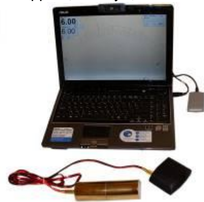
Прибор по измерению КГР – «Индикатор психо-эмоциональных реакций» (ИПЭР-1К)
